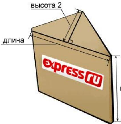
$h$  - высота1,  $S_{\text{треуг}}$  - площадь треугольника, лежащего в основании тубуса, рассчитывается по формуле Герона.
